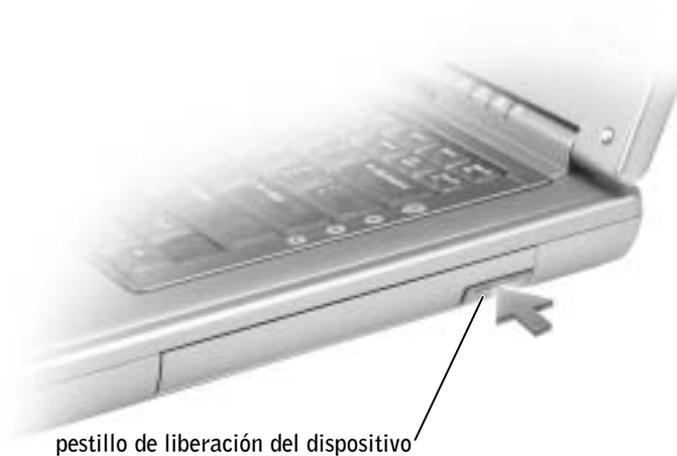
**NOTA:** Si no está instalado el tornillo del dispositivo, puede extraer e instalar dispositivos mientras el equipo está encendido y conectado (acoplado) a un dispositivo de acoplamiento.
